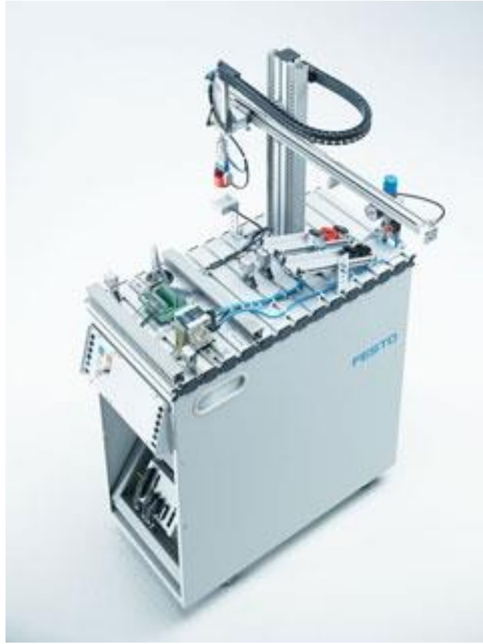
Figura 7 Estación de manipulación [18].
