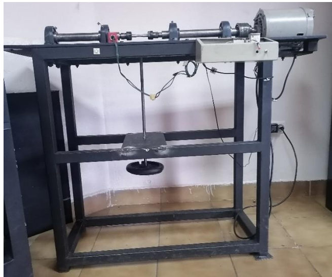
Figura 19. Máquina de flexión rotativa con una capacidad de 295 N.
