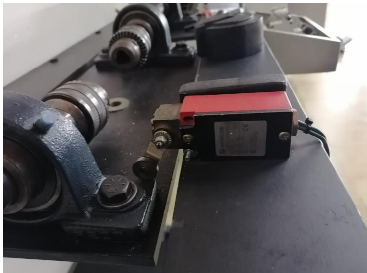
Figura 24. Switch de fin de carrera, accionado por la placa perteneciente a la zona de ensayo.
