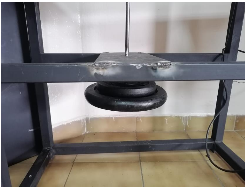
Figura 67. Placa soldada, para mayor estabilidad del peso.
