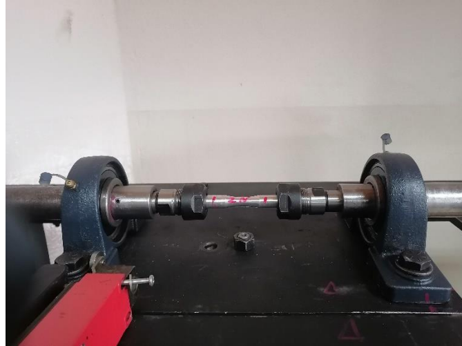
Figura 20. Acercamiento al nuevo sistema de sujeción con una probeta de muestra.
