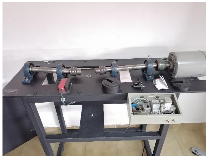
Figura 13. Máquina de ensayo de metales sometidos por flexión rotativa con capacidad de 30 kgf-m.
