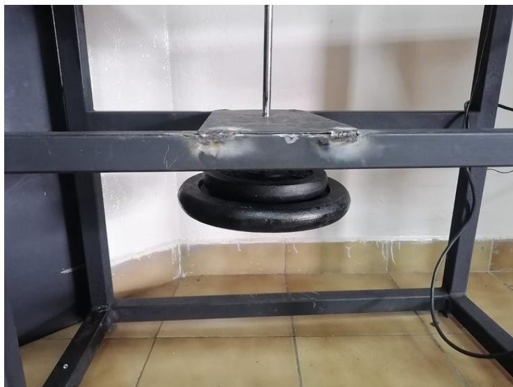
Figura 21. Sistema para el uso de pesos para el ensayo de flexión rotativa.
