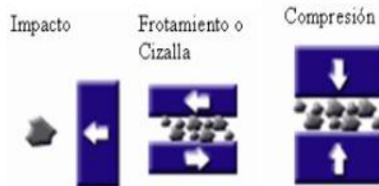
Figura 6. Tipos de fuerzas que generara fragmentación [11]
