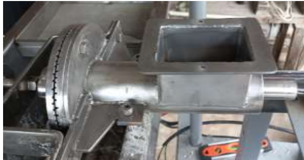
Figura 48. Prototipo 2: Molino con nueva entrada tipo rectangular y desmontable con pernos normalizados.
