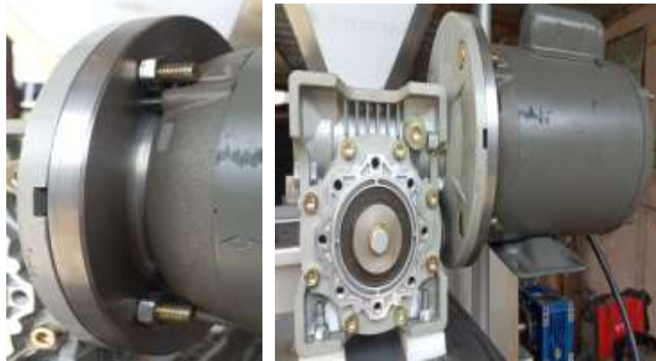
Figura 39. Bridas para la adaptación del motor con el reductor para el molino.
