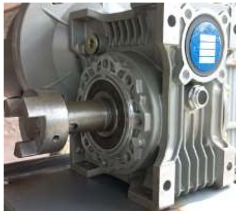
Figura 38. Eje para la adaptación del reductor hacia el tornillo sin fin del molino mediante un matrimonio.
