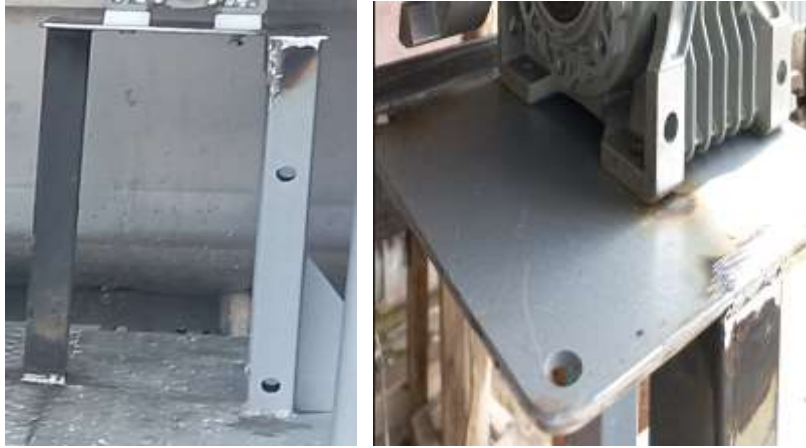
Figura 45. Base para el motoreductor del molino.
