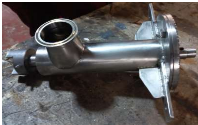
Figura 47. Prototipo 1: Molino con entrada cónica y adaptable con ferrul de diámetro 2 plg.
