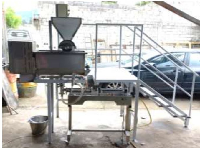
Figura 50. Molino dosificador terminado.
