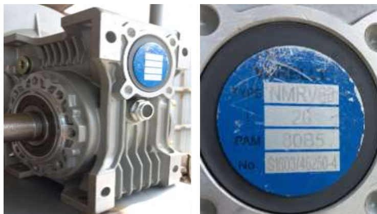
Figura 21. Caja Reductora seleccionada.
