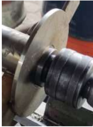
Figura 31. Disco de soporte para el disco fijo.
