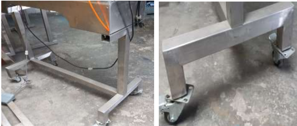
Figura 40. Bastidor o soporte para el dosificador.
