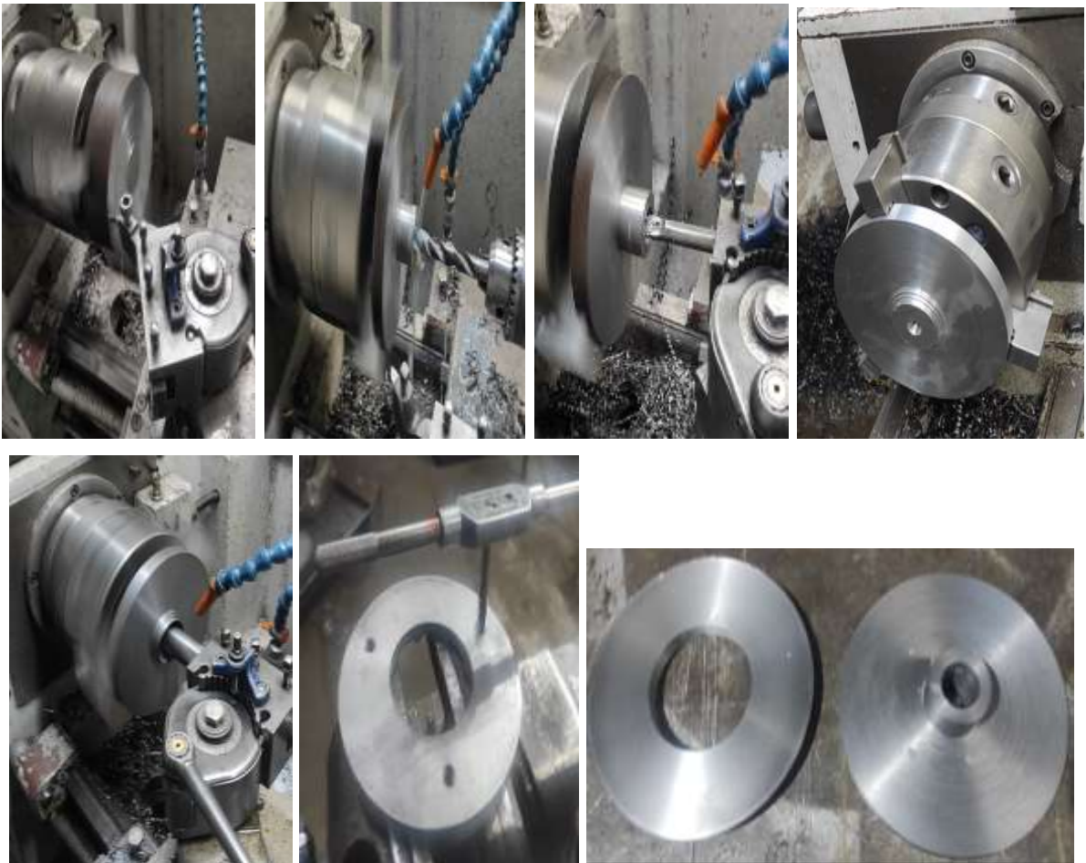
Figura 29. Disco fijo y móvil diámetro 150 mm.
