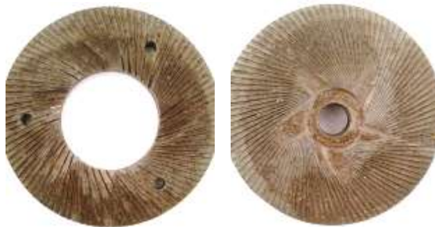
Figura 22. Discos con tratamiento térmico de cementación.
