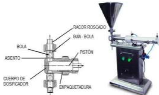
Figura 14. Dosificador volumétrico por pistón [9].
