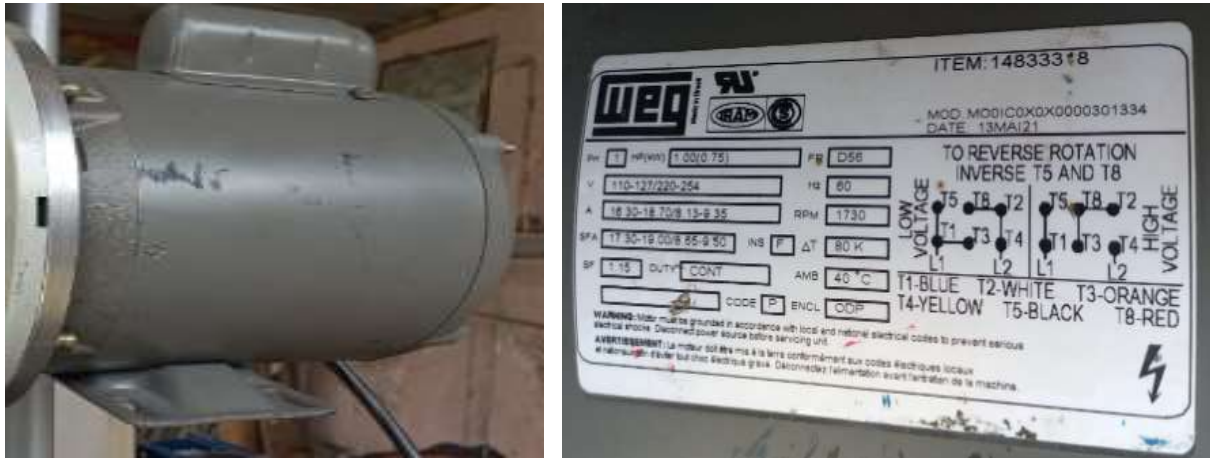
Figura 20. Motor eléctrico monofásico seleccionado.
