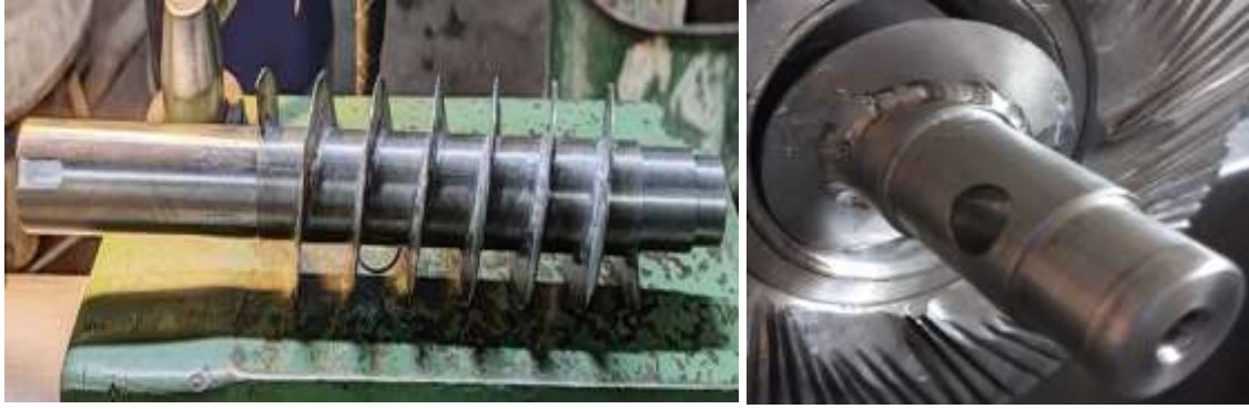
Figura 30. Eje motriz y tornillo sin fin.
