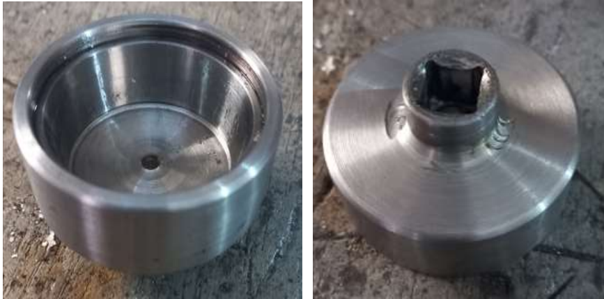
Figura 33. Tapa o recubierta para el rodamiento.
