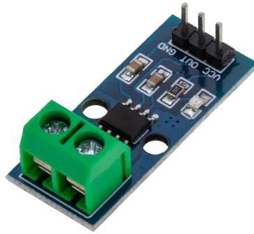
**Figura 17** Modulo sensor de corriente continua
