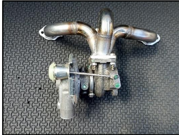
Figura 20. Múltiple de escape y adaptador del turbo.
