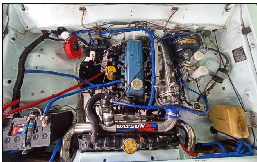
Figura 31. Motor Nissan J15 con turbocompresor
