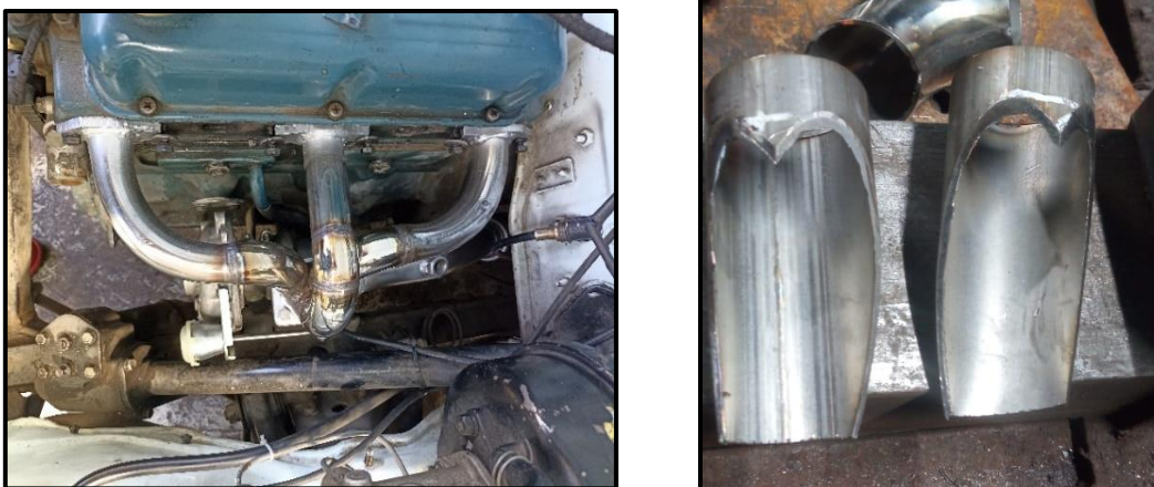
Figura 19. Múltiple de escape y adaptador del turbo.
