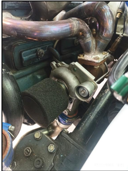
Figura 30. Turbocargador con la válvula wastegate.
