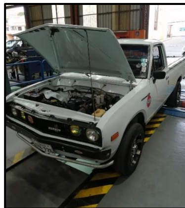
Figura 9. Sincronización del vehículo con el banco dinamométrico
