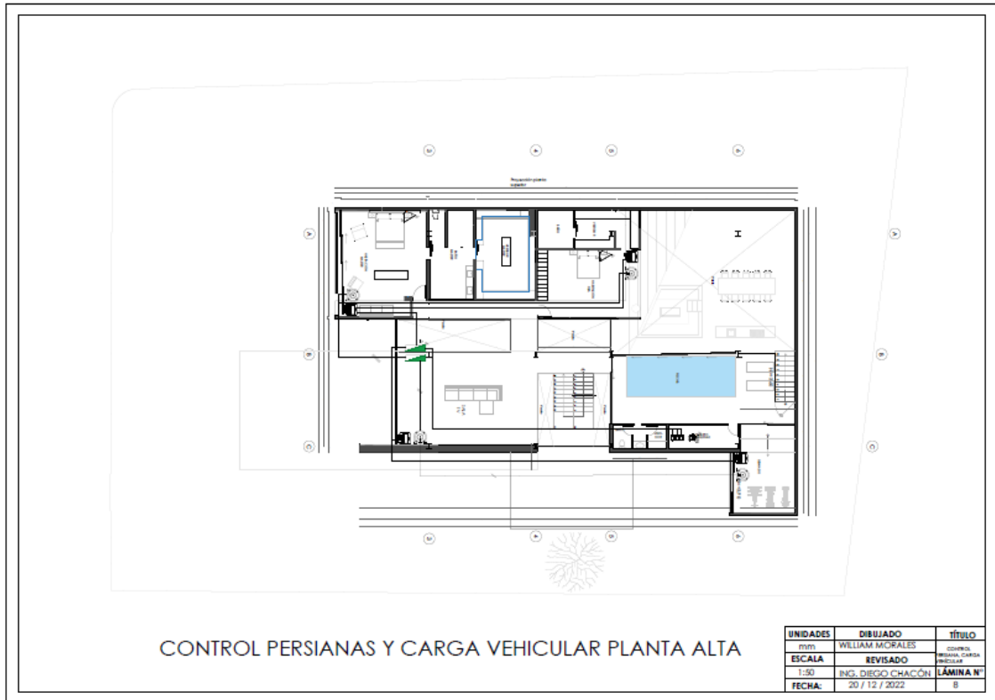
Ilustración 95 Plano del diseño de control de persianas y carga vehicular con Loxone planta alta.
