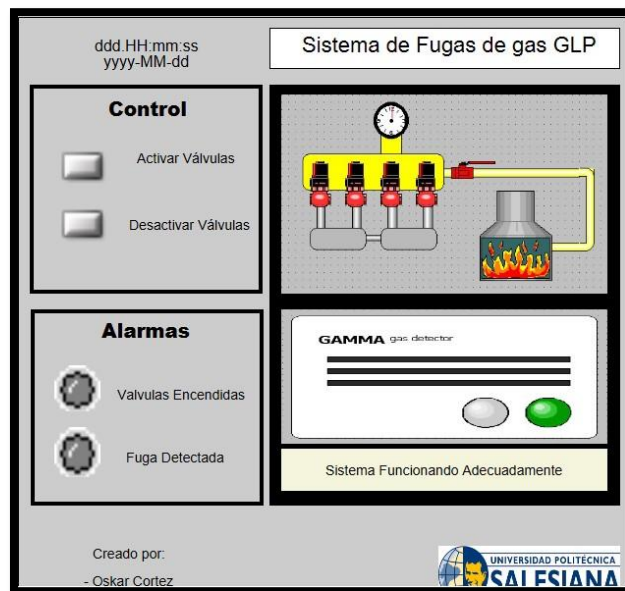
Figura 3.6: Ventana principal del SCADA Web
