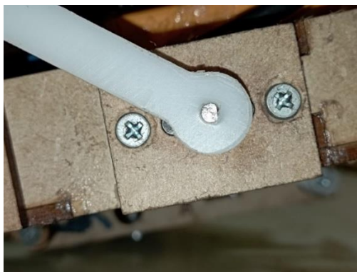
Figura 5.3 Extremidad Robot Trepador en Duralón
