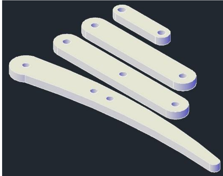
Figura 3.20 Articulaciones robot insecto
