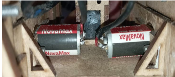
Figura 3.29 Motorreductor metálico NovaMax
