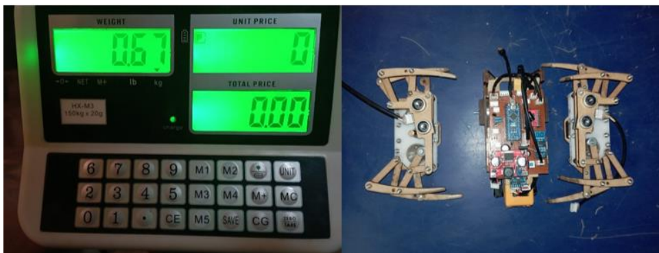
Fotografía peso en kilogramos del diseño para la categoría de insecto con pernos de 3mm, Miguel Uvillus
