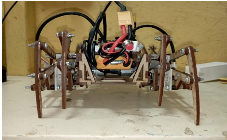
Figura 3.38 Prototipo Robot Categoría Insecto Prueba 3
