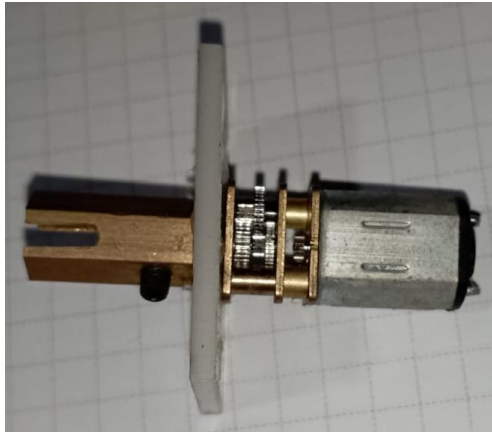
Figura 3.28 Micromotor 2 sin Encoder
