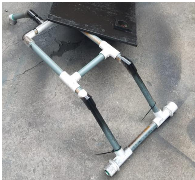
Chasis del robot con la base de madera, Elaborado por: David Quiroga, Boris Rubio
