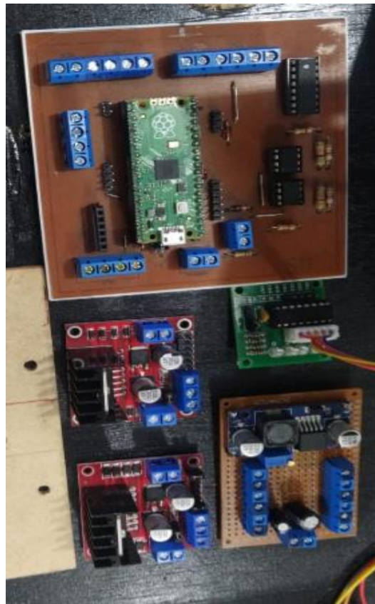
Parte superior del robot, elementos electrónicos, placas de desarrollo y batería. Elaborado por David Quiroga, Boris Rubio.
