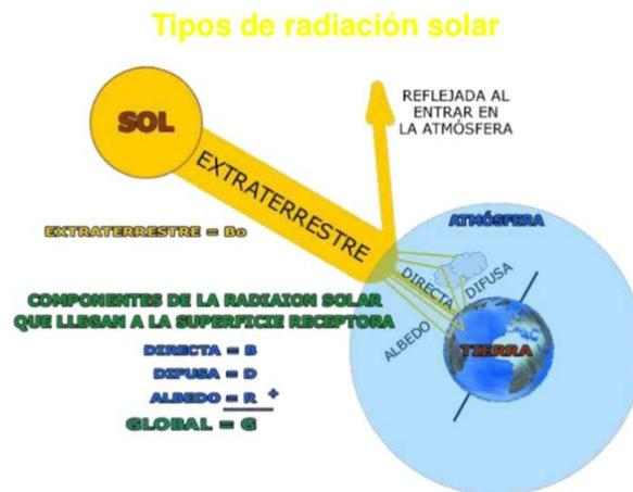
Figura 6. Tipos de radiación solar [11].
