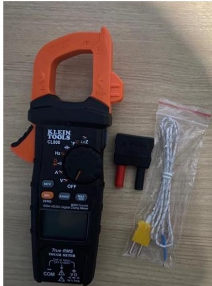
**Figura 43.** Multímetro y termopar tipo K usado en la medición de la piscina pequeña.
