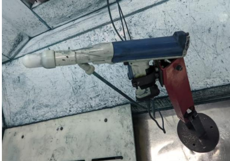
Figura 13. Aplicador de pintura estático. [Autor]
