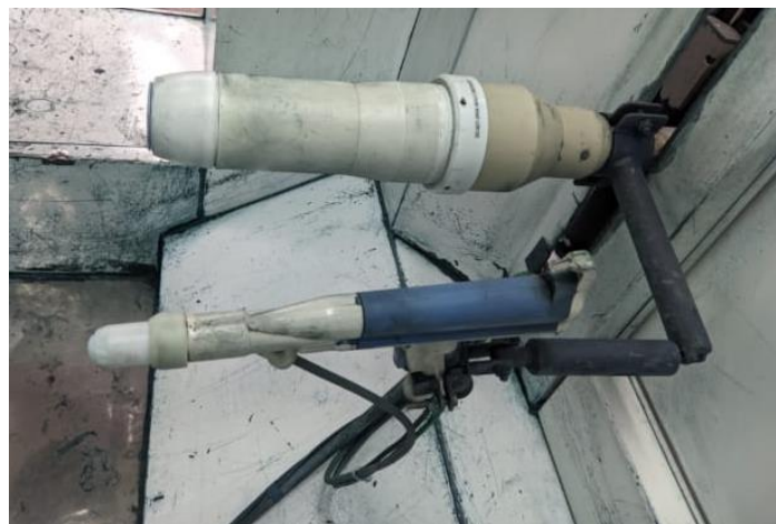
Figura 12. Aplicador de pintura móvil. [Autor]
