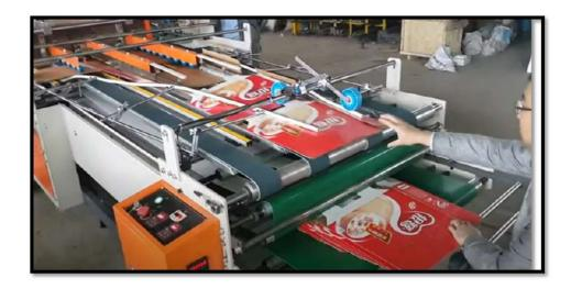
**Nota:** Se realiza un proceso de conteo manual del cartón, realizado por un operador, la velocidad de la producción esta relacionada con la capacidad del operador, tomado de (Waste stripper carton, 2017).
