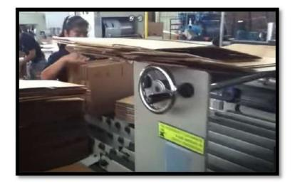
**Nota:** A pesar de poseer un sistema de conteo el proceso vuelve a repetirse de manera manual debido a que el diseño del dispositivo no proporciona un volumen adecuado de salida respecto al valor del contador. Tomado de (sammexdemexico, 6, septiembre, 2012).
