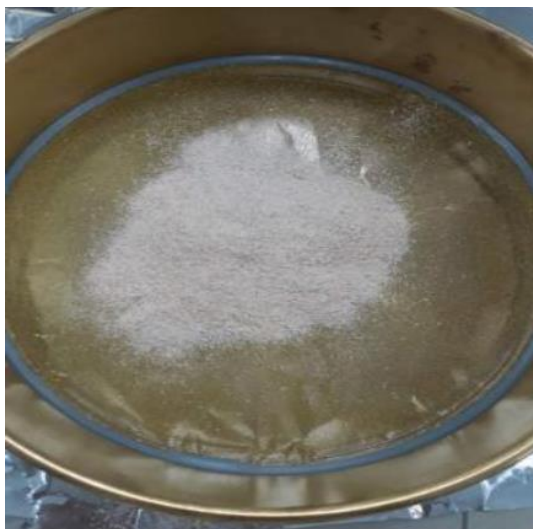
Figura 5 Tamizador con Malla # 50
