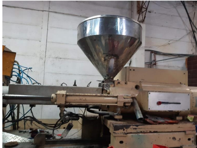
Figura 15 Alimentación de la maquinaria y moldeado
