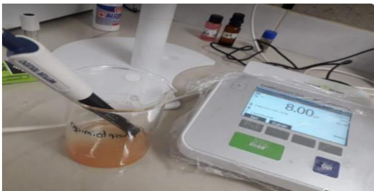
Figura 10 Potenciómetro con Regulador para Quimotripsina
