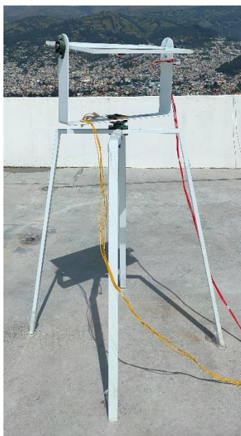
Figura 0.8 Estructura Seguidor Solar
