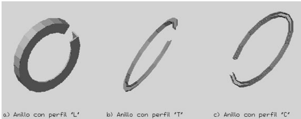
Figura 7. Anillos obtenidos a partir de diferentes perfiles, [13].
