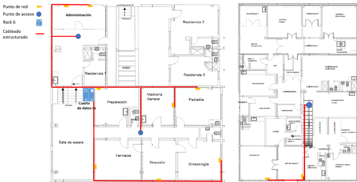
Cableado horizontal del edificio Maternidad – Emergencia.
