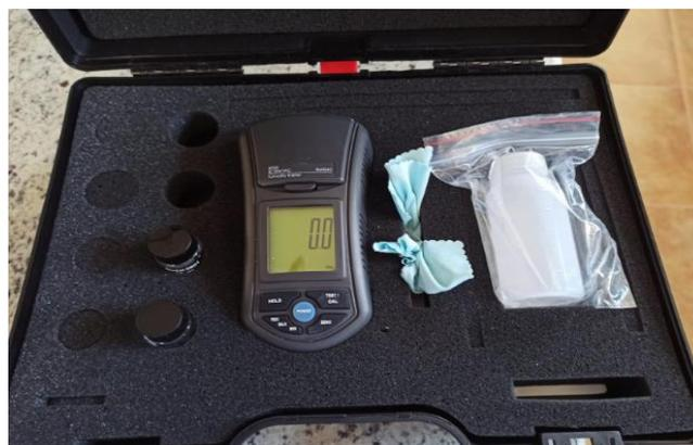
*Nota.* En la fotografía se observa un turbidímetro el cual fue usado para la medición de la turbidez. La fotografía fue tomada por *Gordillo S. & Morocho J. (2023)*.
