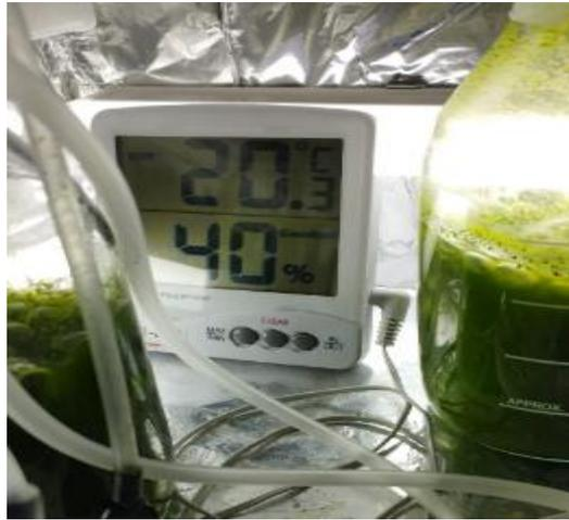
*Nota.* En la fotografía se observa un termohigrómetro digital el cual fue usado para la medición de temperatura ambiente en el fotobiorreactor. La fotografía fue tomada por *Gordillo S. & Morocho J. (2023)*.
