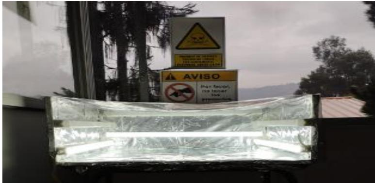
*Nota.* En la fotografía se aprecia el fotobiorreactor usado para mantener las condiciones ideales para el desarrollo de la microalga. La fotografía fue tomada por *Gordillo S. & Morocho J. (2023)*.
