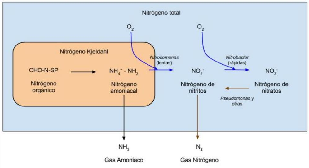
*Nota.* El gráfico representa las etapas del ciclo del nitrógeno en un tratamiento de aguas residuales, el nitrógeno es oxidado de nitrógeno orgánico hasta llegar a nitratos, esta forma del nitrógeno es la que puede ser tratada con la microalga *Chlorella Vulgaris*. La figura fue extraída de Li, Y., Chen, P., & Martinez, B. (2011).
