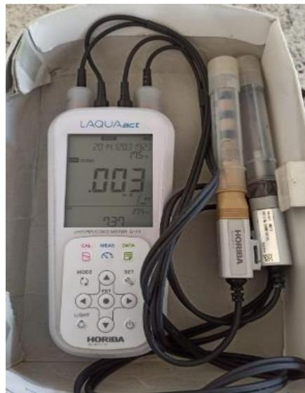
*Nota.* En la fotografía se observa un medidor portátil LACUA act el cual fue usado para la medición del pH y la conductividad. La fotografía fue tomada por *Gordillo S. & Morocho J. (2023)*.
