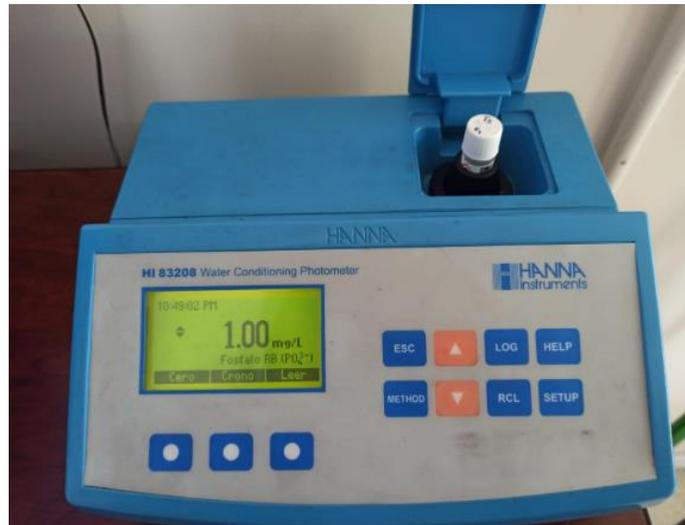
*Nota.* En la fotografía se observa un fotómetro el cual fue usado para la medición de la concentración de fosfatos. La fotografía fue tomada por *Gordillo S. & Morocho J. (2023)*.
