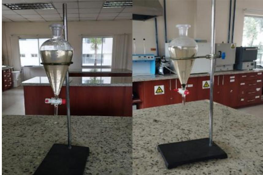
*Nota.* En la fotografía se evidencia la separación de sedimentos, seguidamente se expone el agua residual por dos semanas en oxigenación constante para disminuir la carga de nitrógeno. La fotografía fue tomada por *Gordillo S. & Morocho J. (2023)*.
