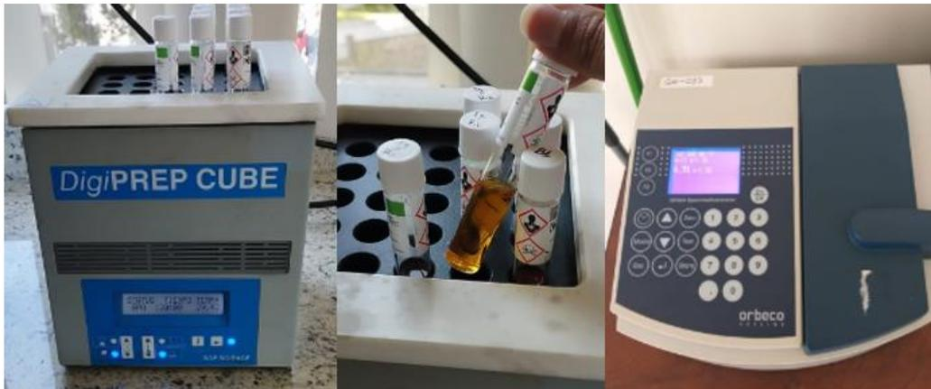
*Nota.* En la fotografía se observa un digestor que fue usado para calentar las muestras y realizar la medición de DQO en un espectrofotómetro. La fotografía fue tomada por *Gordillo S. & Morocho J. (2023)*.
