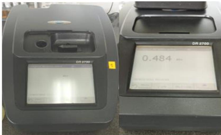
*Nota.* En la fotografía se aprecia un espectrofotómetro que fue utilizado para determinar la curva de crecimiento por medio de la absorbancia. La fotografía fue tomada por *Gordillo S. & Morocho J. (2023)*.
