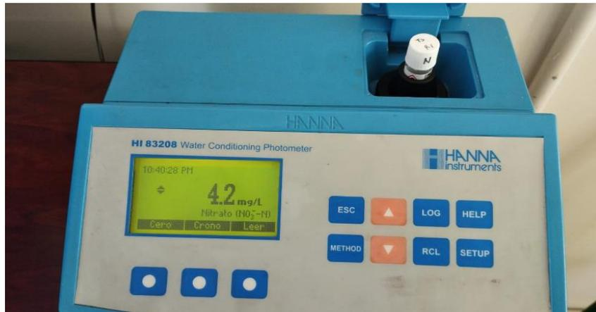
*Nota.* En la fotografía se observa un fotómetro el cual fue usado para la medición de la concentración de nitratos. La fotografía fue tomada por *Gordillo S. & Morocho J. (2023)*.
