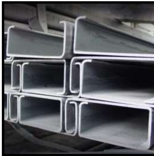
Figura 23 Perfiles tipo “G” de acero estructural A36[10]
