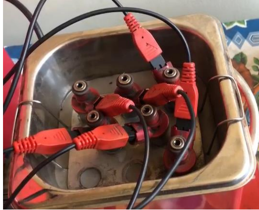
Ilustración 2-26 Limpieza de inyectores.
