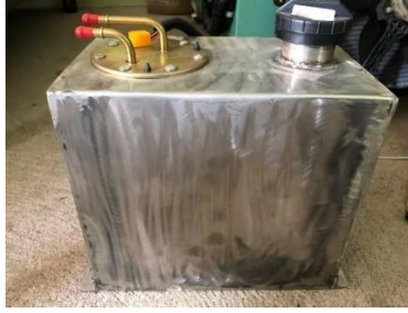
Ilustración 3-6 Tanque de combustible.
