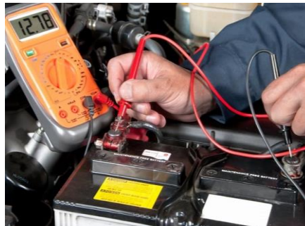
Ilustración 7 Comprobación del estado de la batería. (endado, 2022)
