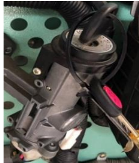
Ilustración 10 Switch de encendido. (TECSA, 2022)
