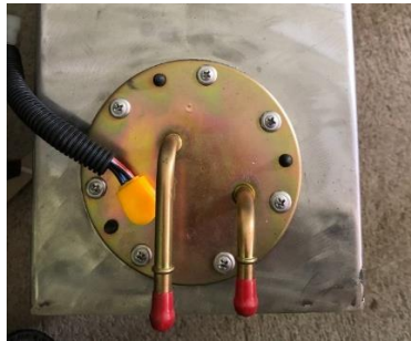
Ilustración 3-7 Bomba de combustible.
