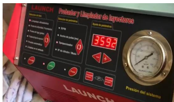
Ilustración 2-25 Limpieza de inyectores.
