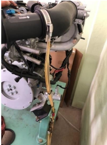
Ilustración 3-4 Cañería de alta presión.
