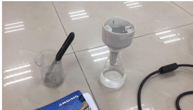
Figura 23. Preparación de la muestra para el proceso de filtración
