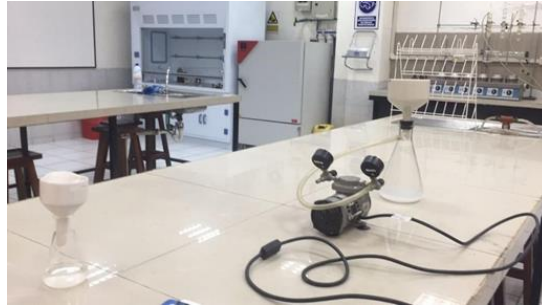
Figura 22. Método de filtración de las muestras obtenidas
