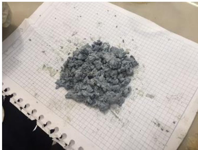
Figura 20. Obtención de la masa de Oxido de Zinc de las pilas usadas
