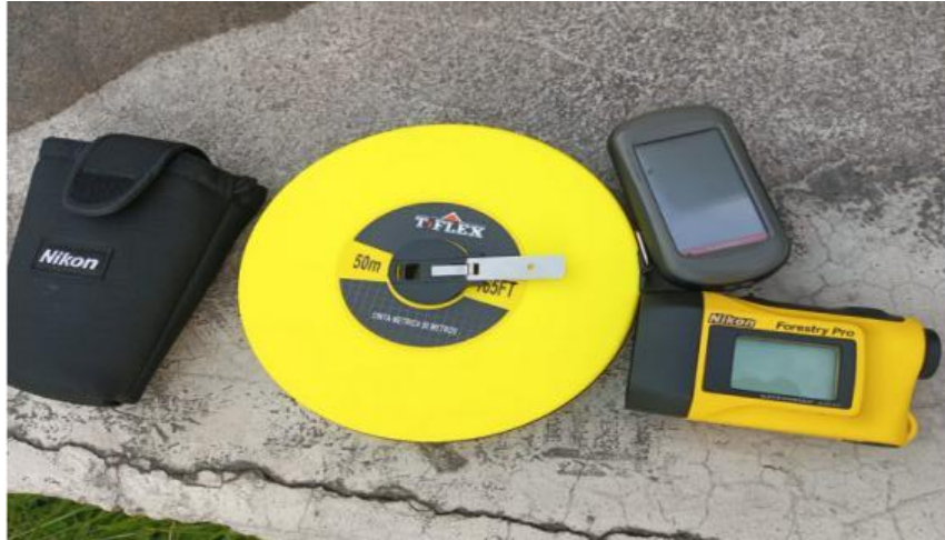
Figura 24. Equipos utilizados para la toma de datos en campo: Hipsómetro Nikon Forestry Pro, GPS y flexómetro.
