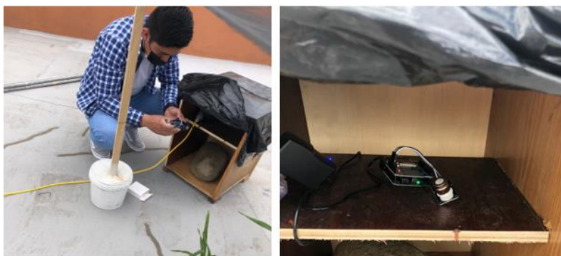
Ilustración 22. Colocación de los sensores de CO2 en los puntos de muestreo.
