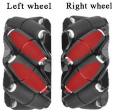
Figura 14. Orientación de los rodillos para las ruedas zurda con ángulo \alpha=45 y diestra con ángulo \alpha=-45 [59].
