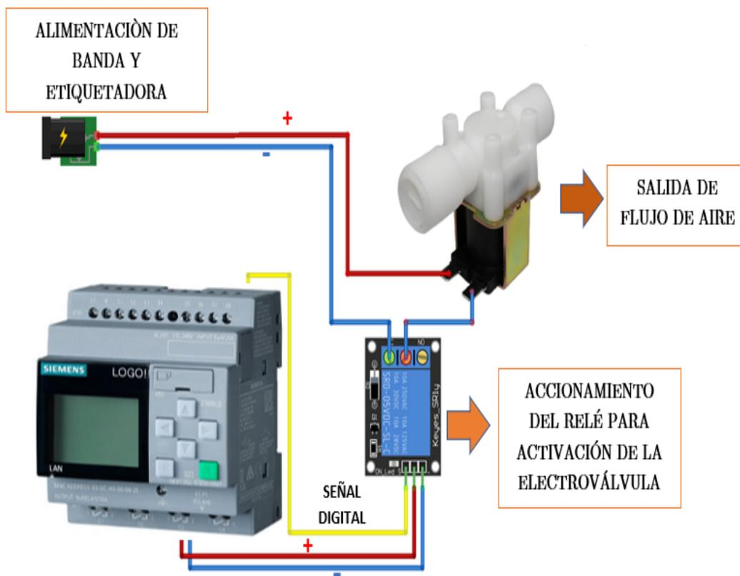
**Nota:** En la siguiente imagen se puede evidenciar el diagrama de conexión para la activación de la electroválvula.
