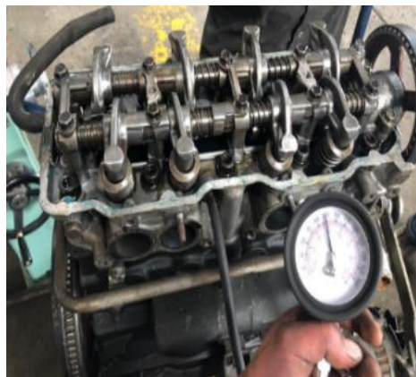
Figura 2. 16 Medición de la compresión cilindro 4
