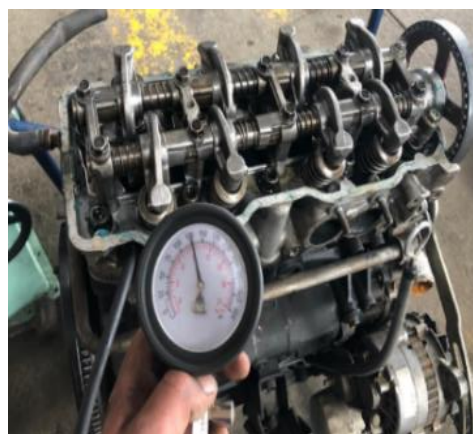
Figura 2. 16 Medición de la compresión cilindro 4
