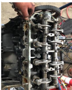
Figura 2. 10 Medición de válvulas 1 y 3
