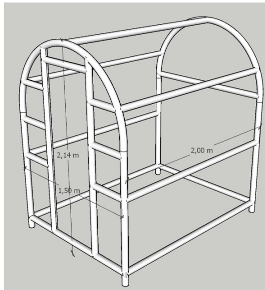
Figura 3.31: Diseño del prototipo(Perspectiva).
