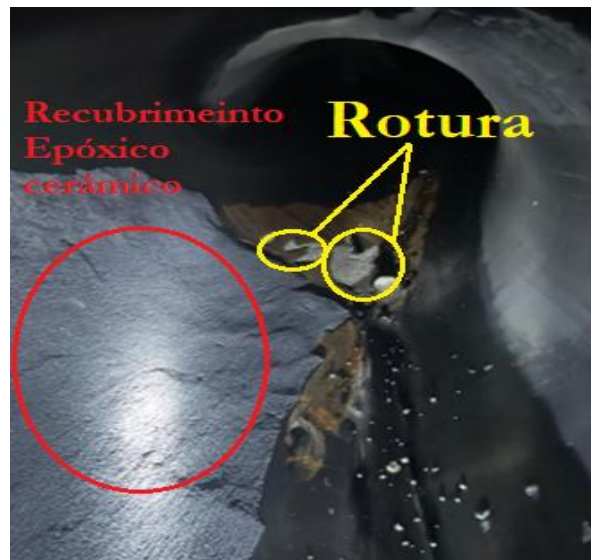
Ilustración 9. Desgaste en el interior de la tubería que transporta relave DN800 PN40.
