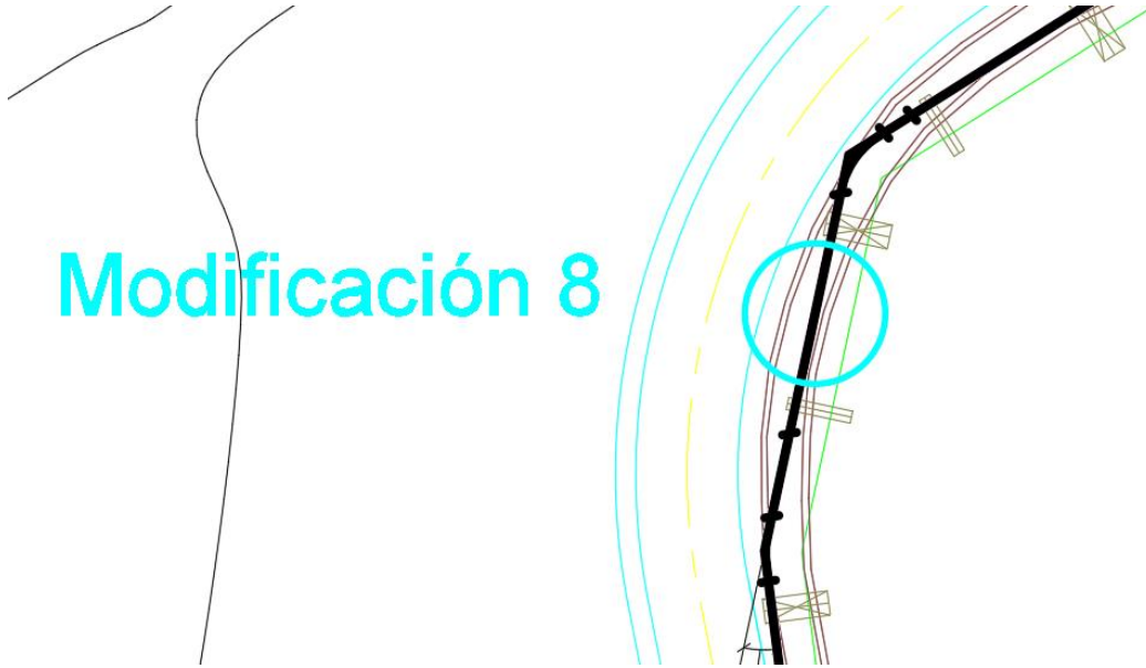
Ilustración 39. Imagen computarizada del punto crítico M8 de la tubería de descarga de relaves del proyecto Mirador.
