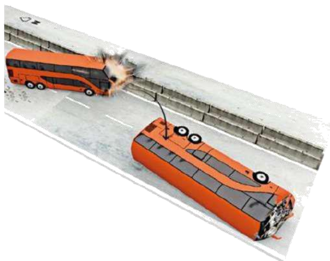
Figura 4. Volcamiento Lateral de Autobús tras Pérdida de Control.
