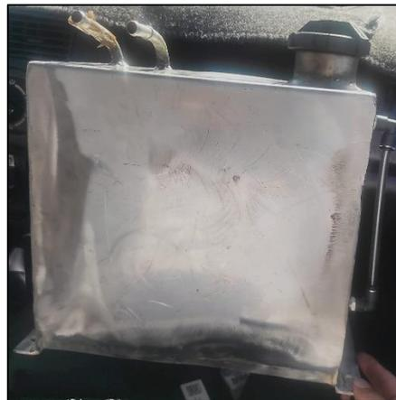
*Ilustración 3-2: Tanque de combustible.*
