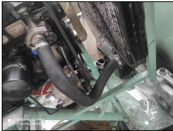
*Ilustración 3-6: Cañería de retorno de refrigerante.*
