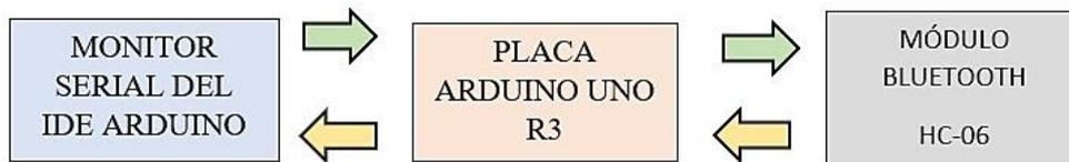
*Ilustración 1-23: Vinculación indirecta entre PC y módulo HC-06 mediante Arduino.*
