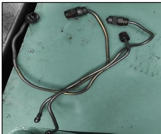
*Ilustración 2-2: Cañería de alta presión.*
