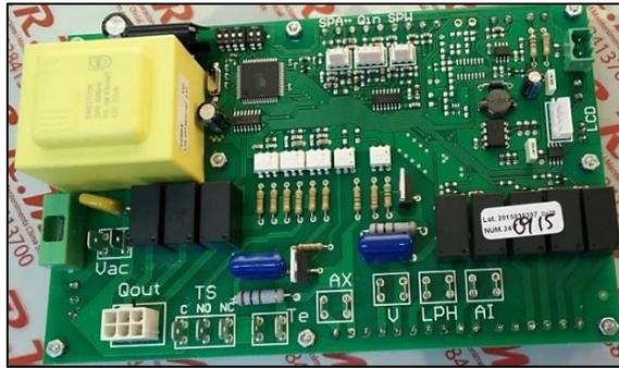
*Ilustración 3-15: Placa del módulo bluetooth*
