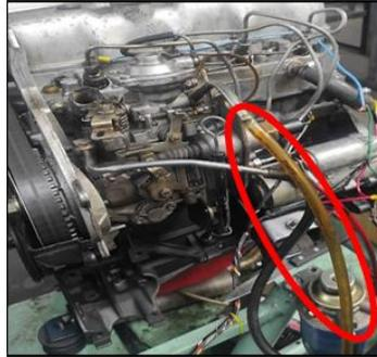
*Ilustración 3-1: Cañería de baja presión.*
