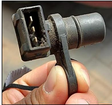
*Ilustración 3-16: Sensor de efecto hall para medir los RPM*
