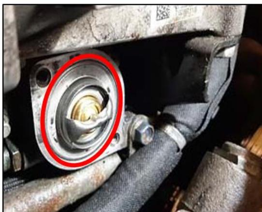
*Ilustración 3-4: Termostato.*
