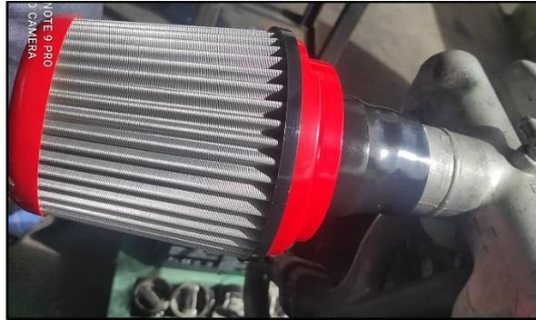
*Ilustración 3-8: Tubo y filtro de aire.*
