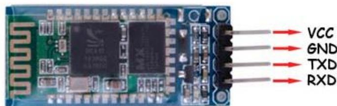
*Ilustración 1-20: Partes del módulo bluetooth HC-06.*
