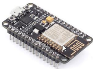
Figura 11. NodeMCU ESP8266 módulo para la programación de protocolos.
