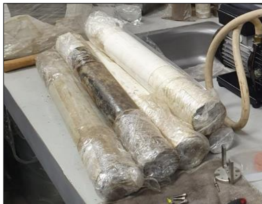
Almacenamiento de Tubos Shelby
