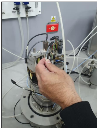
Colocación Sensores Axiales
