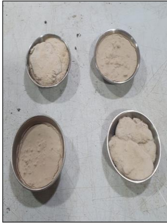
Muestras después de secado al horno para el contenido de humedad.
