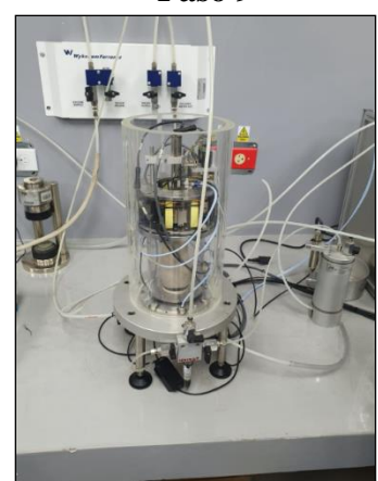
Colocación Cilindro Acrílico
