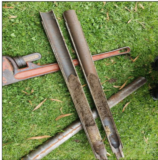
Extracción Muestra Alterada con Cuchara Partida
