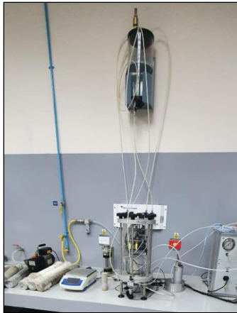
Llenado de Tanque y Desairado con Bomba de Vacíos
