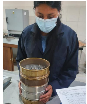
Tamizado de Muestras después del secado.
