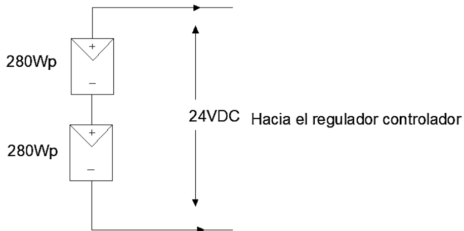
Ilustración 26 - Conexión de los módulos fotovoltaicos Fuente: Autores
