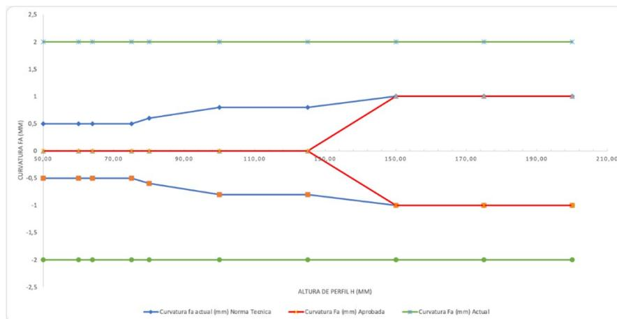
**Figura 28.** Comparación tolerancias actuales y aprobadas proceso de doblado.
