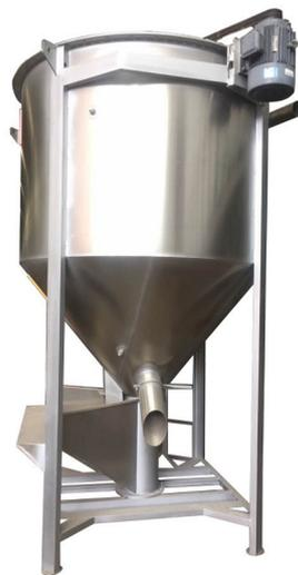
**Figura 5:** Máquina mezcladora de plástico. (Gester, 2019, octubre 21)
