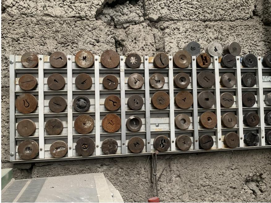
**Figura 52:** Diferentes moldes para la extrusión de los perfiles flexibles
