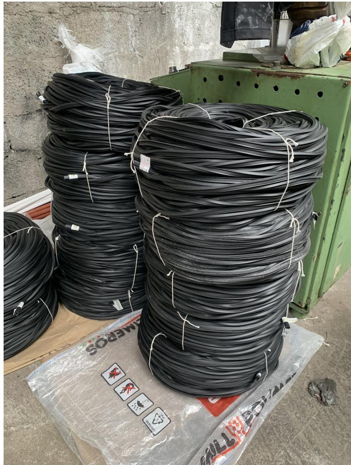
**Figura 53:** Rollos de perfiles flexibles extruidos
