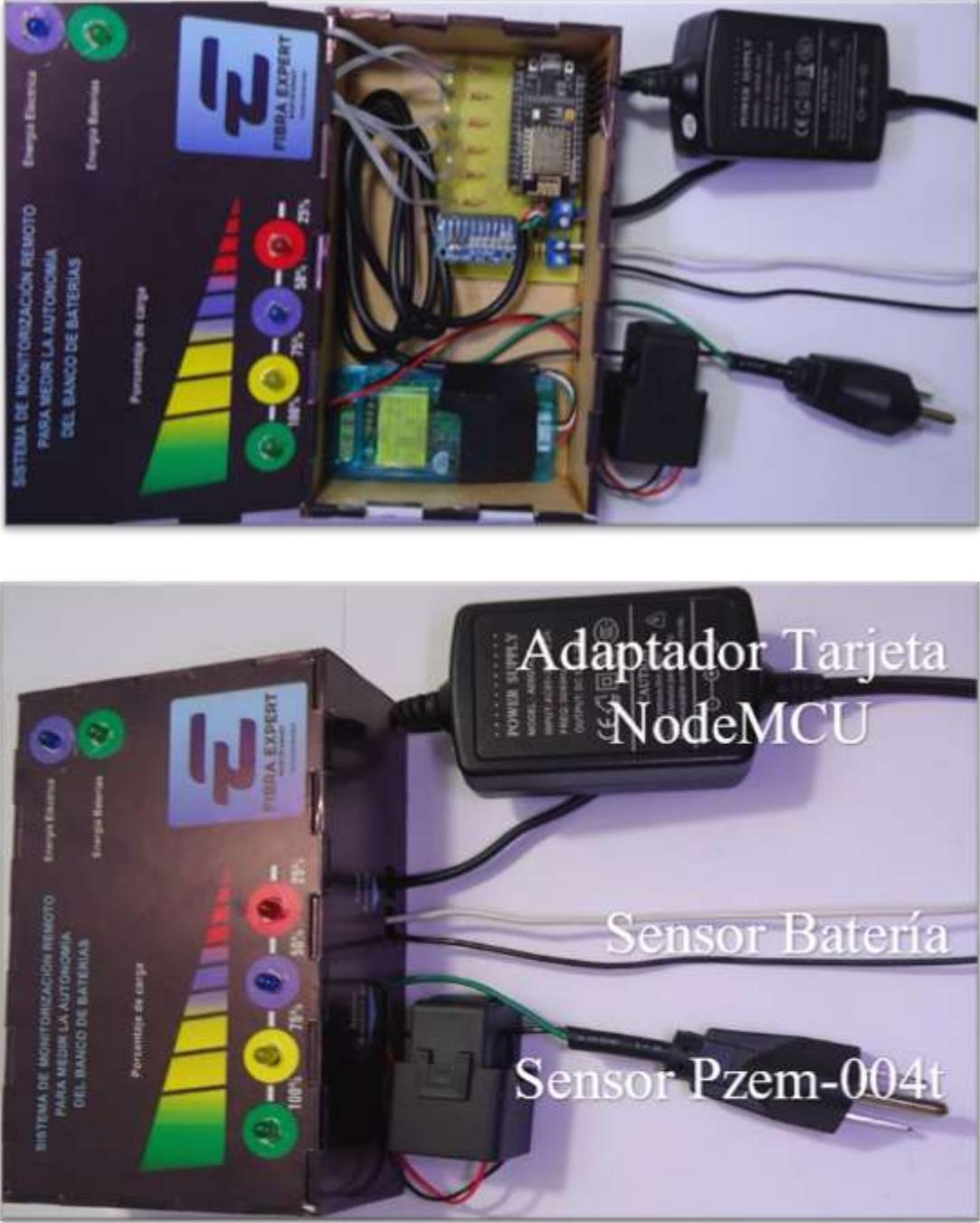
**Nota.** Circuito Físico de Conexión del prototipo implementado en el nodo Escudo. Elaborado por: El Autor.
