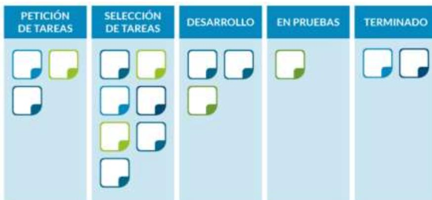
**Nota.** Este esquema subdivide las actividades en varias partes siguiendo una línea horizontal imaginaria. El muro está conformado por distintas columnas que van señalando los estados por los que avanza una determinada tarea. Fuente: (Rogelio Toledo García, CEO AgilePlan).
