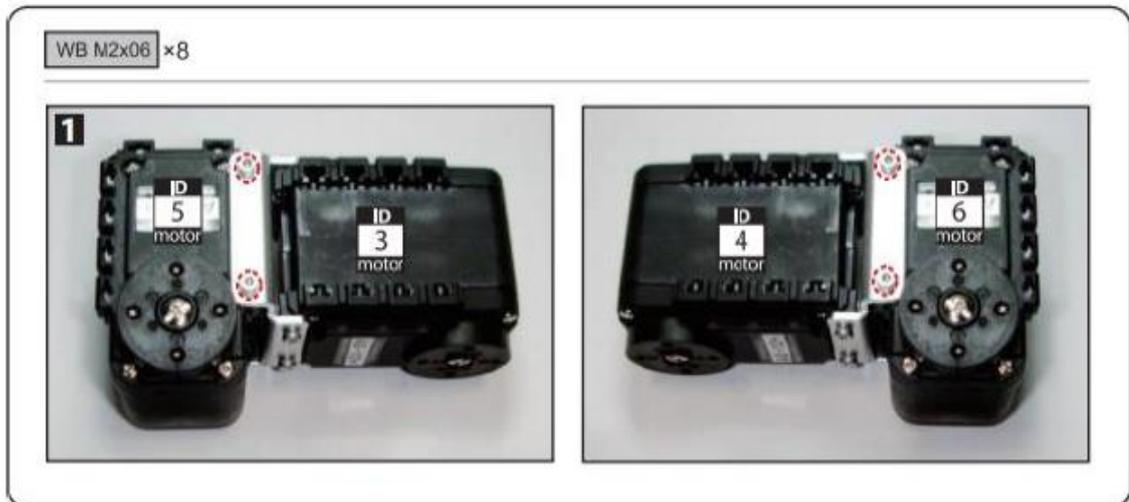
Fig. 32 Fijación de servomotores que conformaran los brazos del robot [17]
