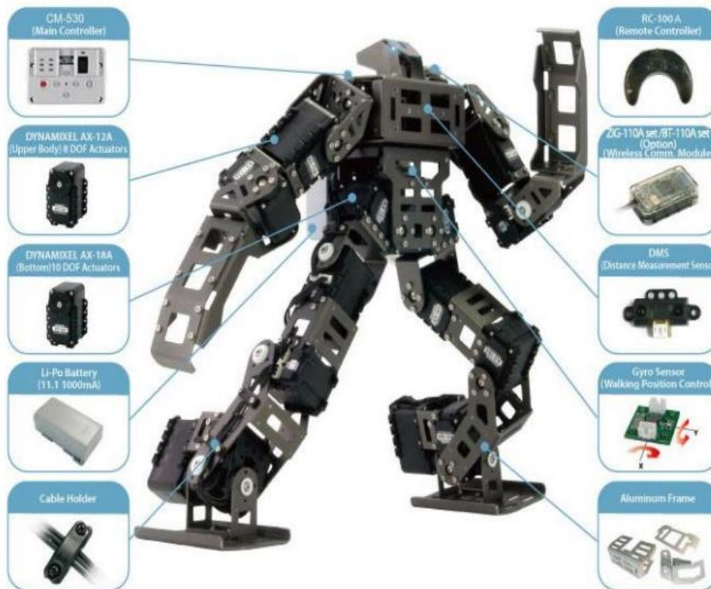
Fig. 1 Componentes del Robot Bioloid GP [1]
