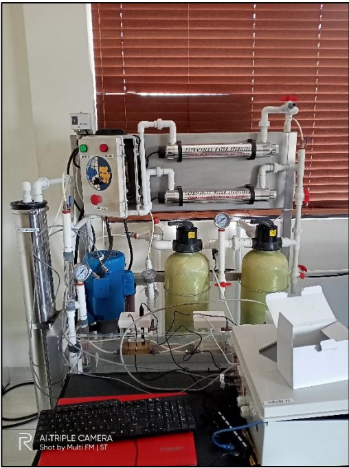
Fig. 59 Planta de nanofiltración
