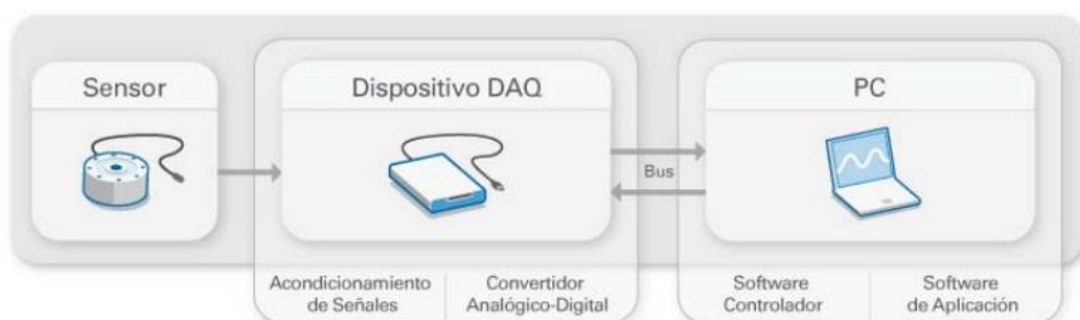
Figura 2-10: Diagrama de un sistema con Daq o Das (Agüero, 2017)
