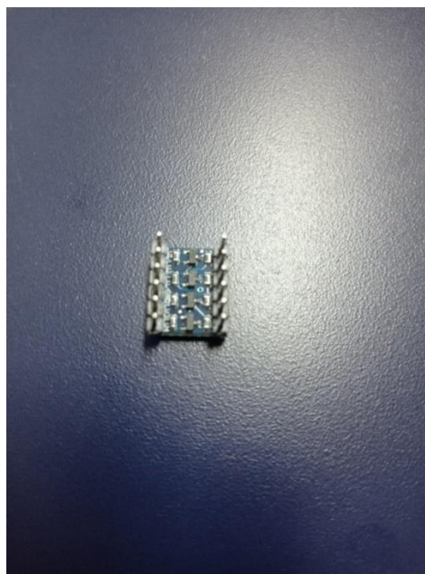
Figura 25. Level Shifter bidireccional 3.3V a 5V
