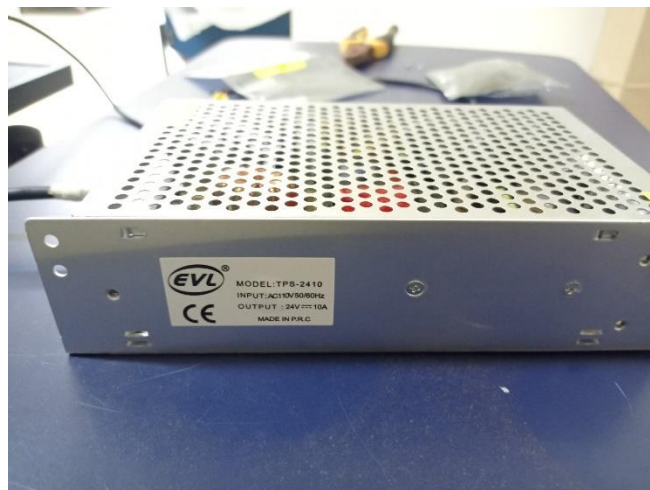
Figura 24. Inversor de 110V a 24V
