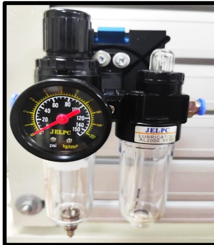
FIGURA 8: UNIDAD DE MANTENIMIENTO
