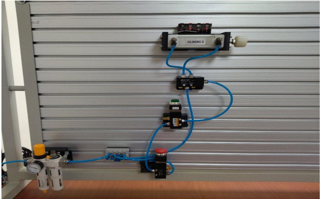
FIGURA 210: IMPLEMENTACIÓN NEUMÁTICA EN EL MÓDULO
