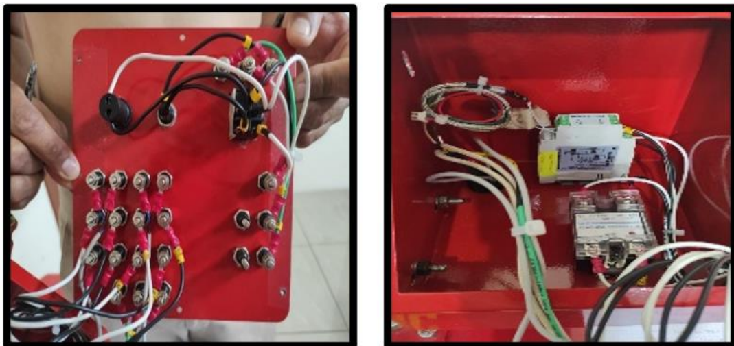
FIGURA 78: CONEXIONES DEL CIRCUITO ELÉCTRICO DE LA SUBLIMADORA
