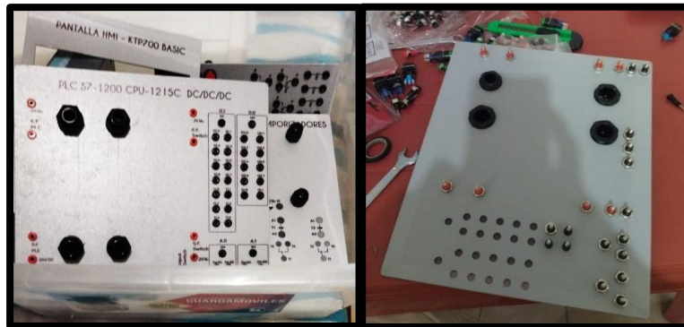
FIGURA 113: MONTAJE DE BORNERAS Y PRENSAS ESTOPA
