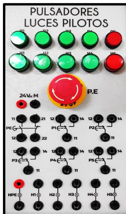
FIGURA 66: LÁMINA DE PULSADORES Y LUCES PILOTO
