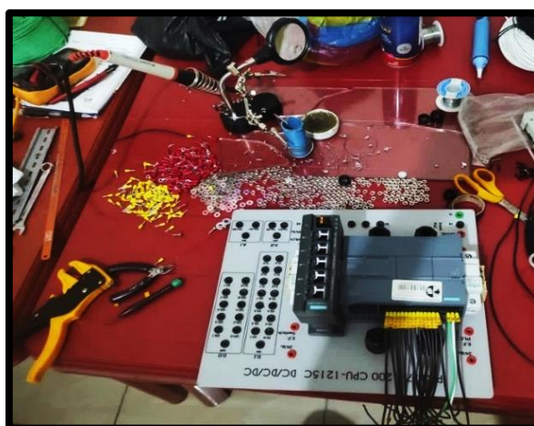
FIGURA 116: CABLEADO Y ACOPLAMIENTO DE MACHUELOS EN LOS TERMINALES
