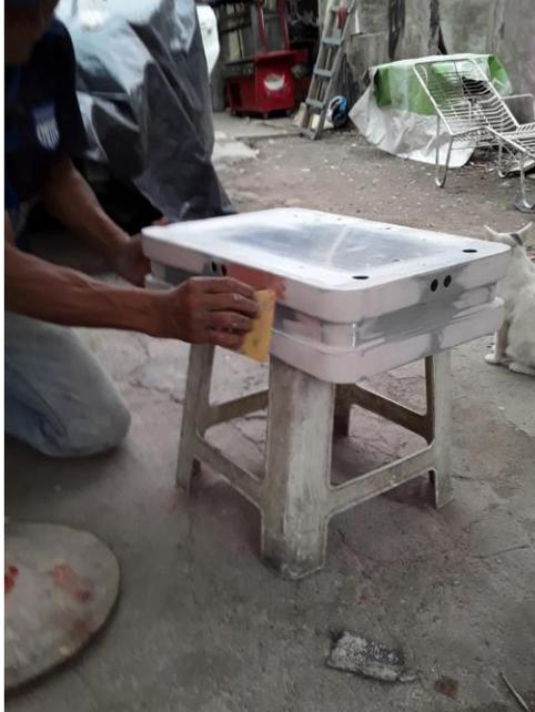
**Figura 98. Proceso de limar las imperfecciones de la estructura del robot**
