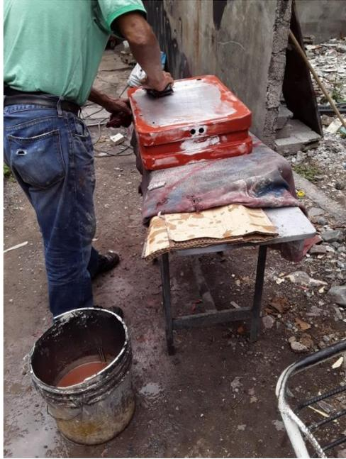
**Figura 99. Proceso de empaste de la estructura del robot móvil**
