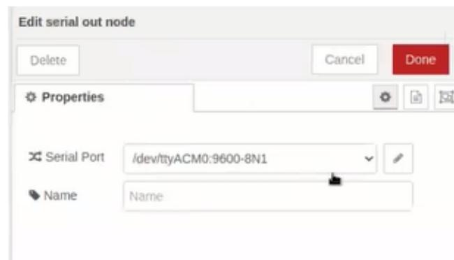
**Figura 85. Editor del nodo de salida de serial.**
