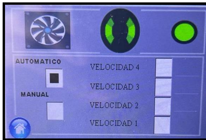
Figura 131. Interfaz del Control automático de velocidad de la turbina.
