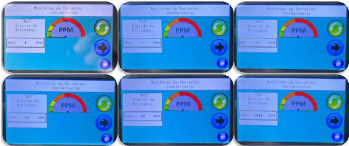
Figura 106. Visualización de datos del Dióxido de Nitrógeno (NO2) en la pantalla HMI Nextion.
