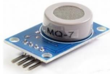
Figura 5. Sensor MQ-7 Compatible con la placa Arduino. (M. Naylamp, 2021)
