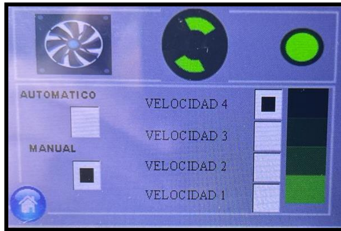
Figura 130. Interfaz del control manual de velocidad de la turbina.
