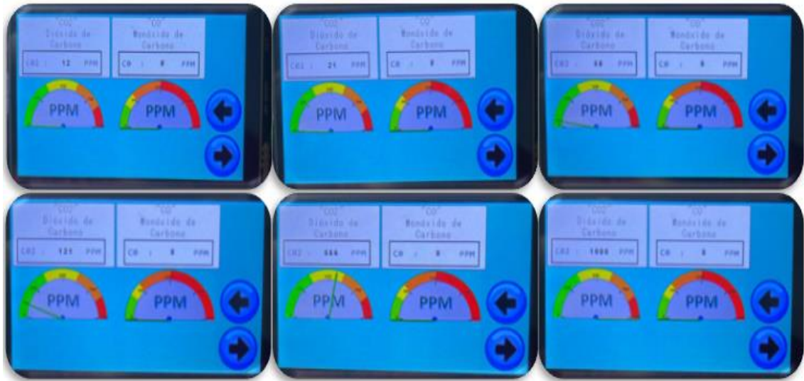
Figura 91. Visualización de datos del Dióxido de Carbono (CO2) en la pantalla HMI Nextion
