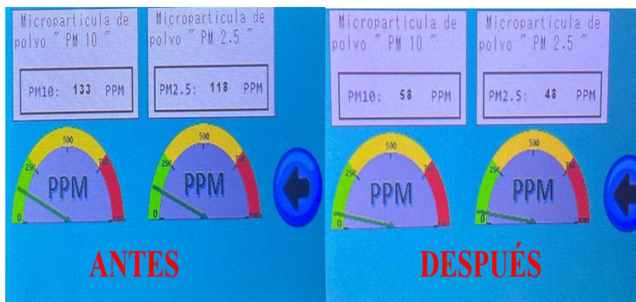
Figura 133. Detección de micropartículas de humo en la pantalla HMI Nextion.
