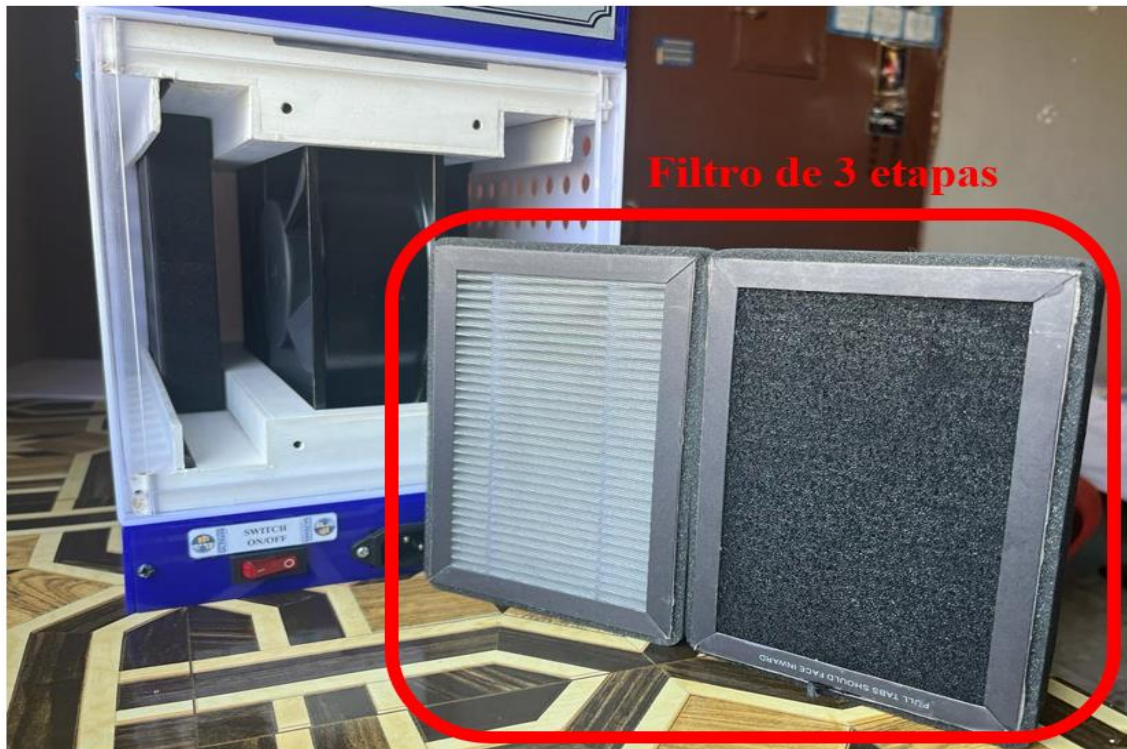
Figura 129. Sistema Purificador de Gases Contaminantes del prototipo.
