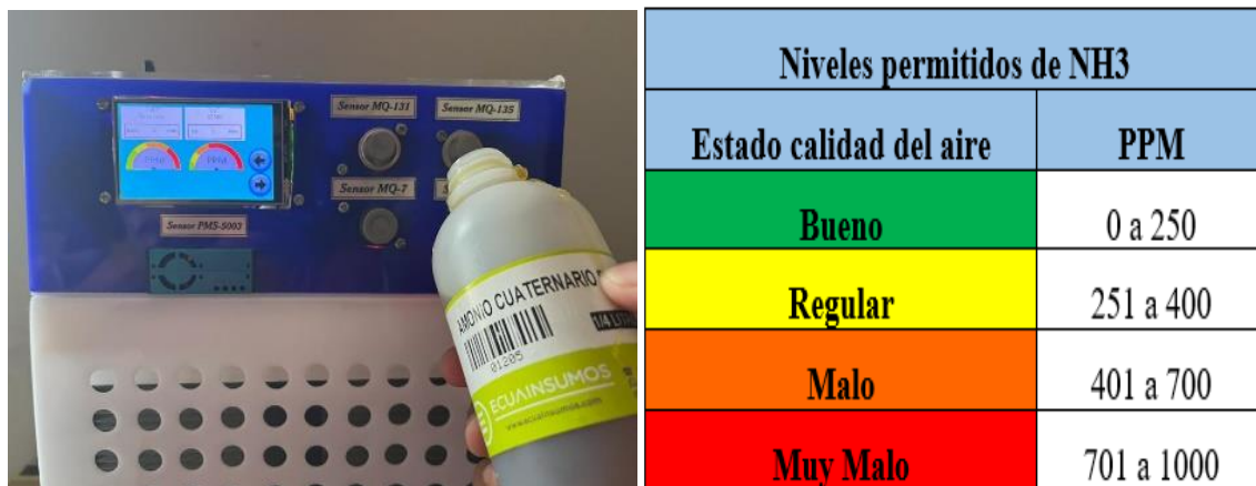
Figura 100. Medición del Amoníaco ( \text{NH}_3 ) con el Sensor MQ-135.
