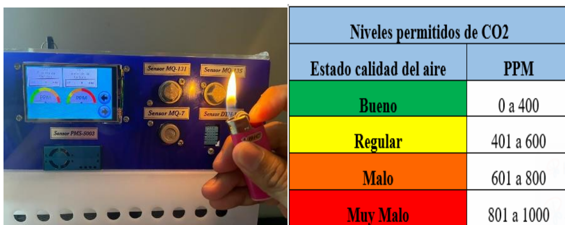
Figura 90. Medición del Dióxido de Carbono (CO 2 ) con el Sensor MQ-135.
