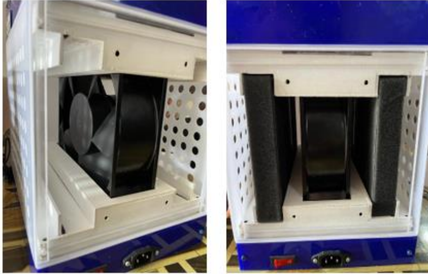
Figura 145. Montaje de la turbina extractora de aire y los filtros de aire.
