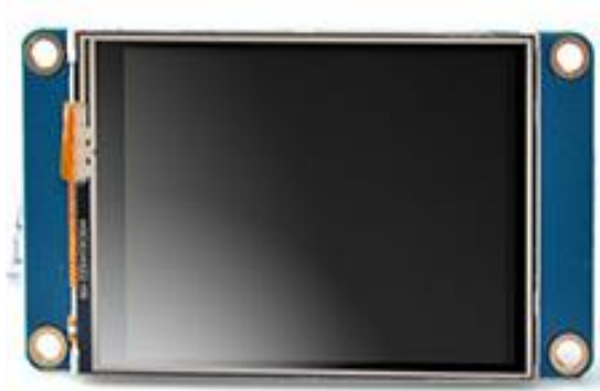
Figura 2. Pantalla Nextion de 2,4” pulgadas.(nextion, 2022)
