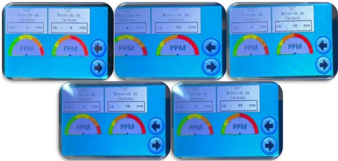
Figura 96. Visualización de datos del Monóxido de Carbono (CO) en la pantalla HMI Nextion.
