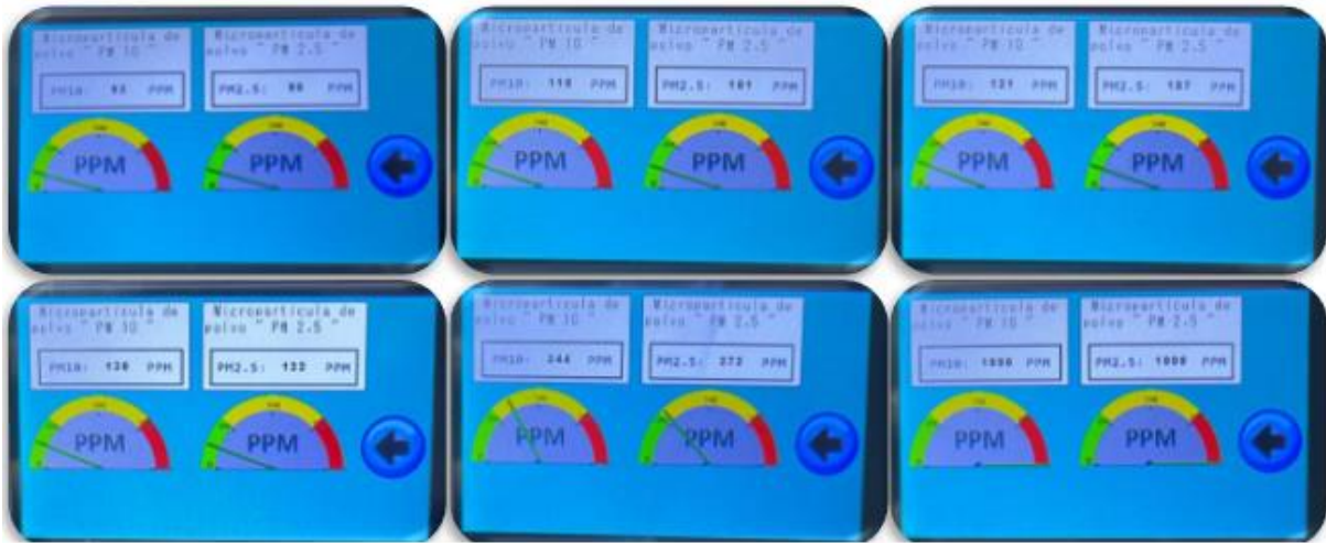
Figura 116. Visualización de datos del material particulado PM 10 y PM 2.5 en la pantalla HMI Nextion.
