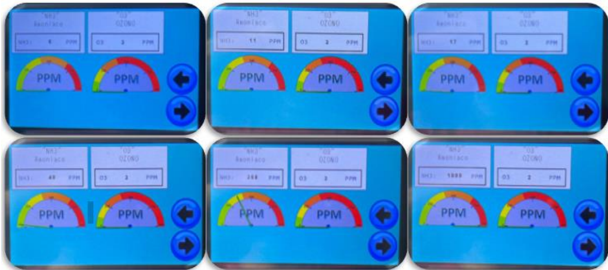
Figura 101. Visualización de datos del Amoníaco (NH3) en la pantalla HMI Nextion.
