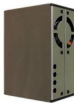
Figura 7. Sensor PMS5003 Compatible con la placa Arduino. (Yong, 2016)
