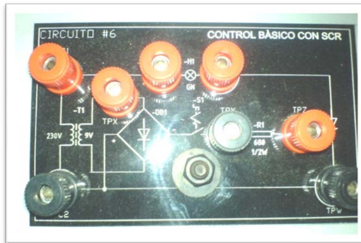
Gráfica 132: Foto del circuito en el panel mímico.
