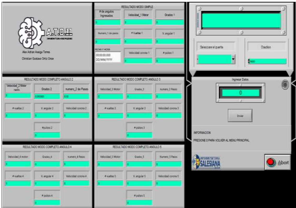
Figura 67. Interfaz gráfica en LabVIEW para la recepción de datos y control del sistema.
