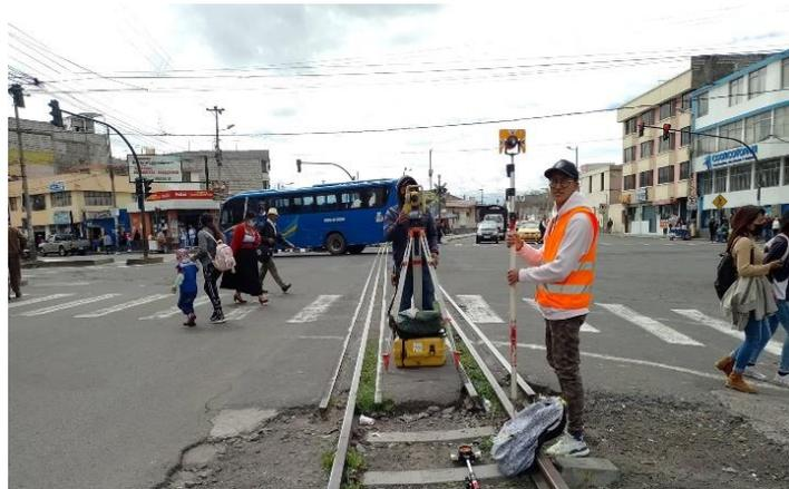
*Nota.* Se muestra el proceso de levantamiento topográfico. Elaborado por: Los Autores
