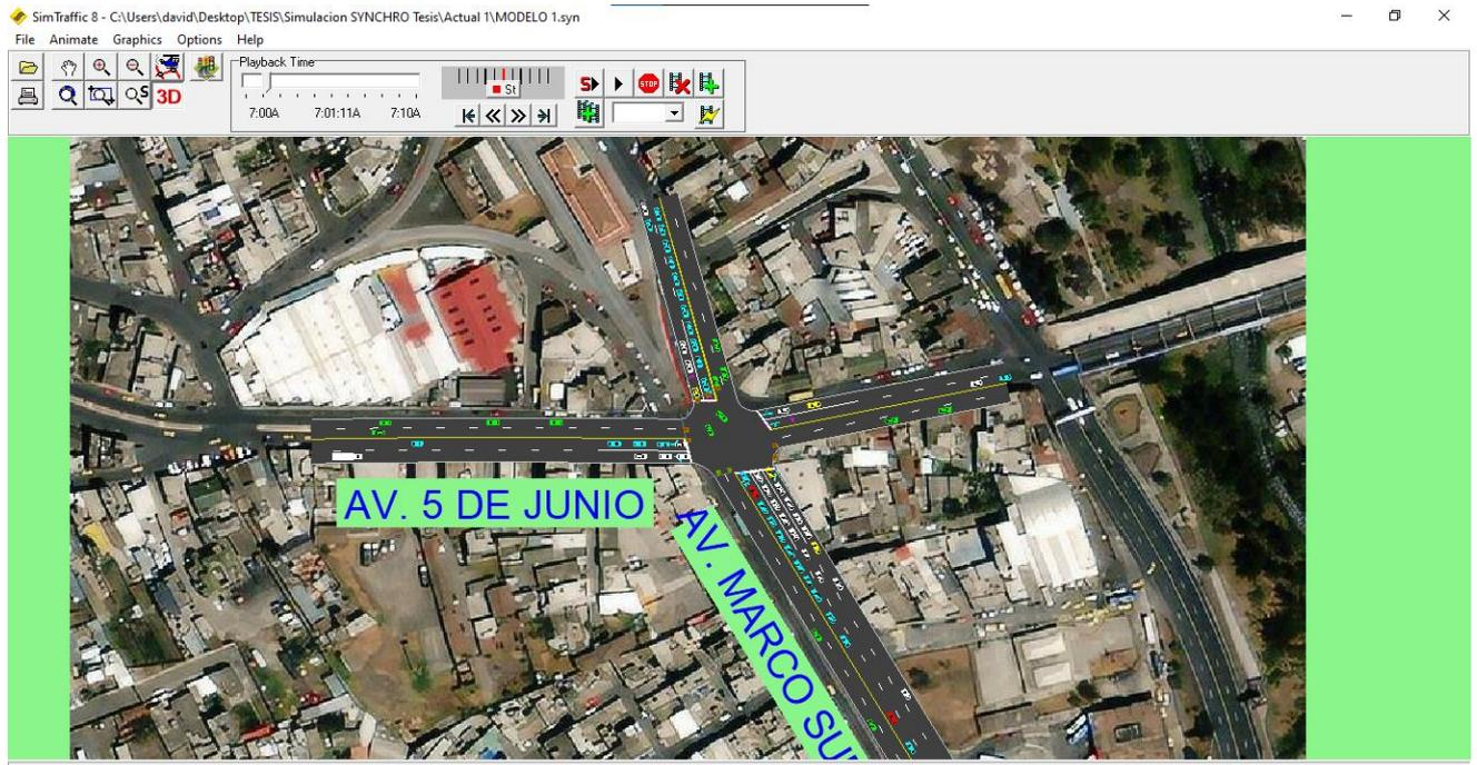
*Nota.* La figura muestra la simulación del tráfico en hora pico. Elaborado por: Los Autores
