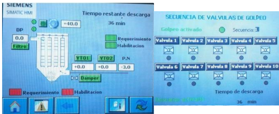
Figura 4.11: Pruebas con la función de descarga del filtro al iniciar.
