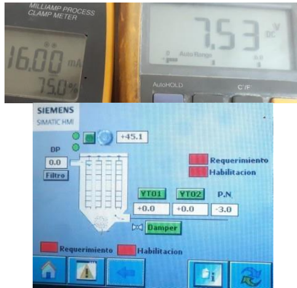
Figura 4.3: Pruebas de la entrada analógica en 16mA.
