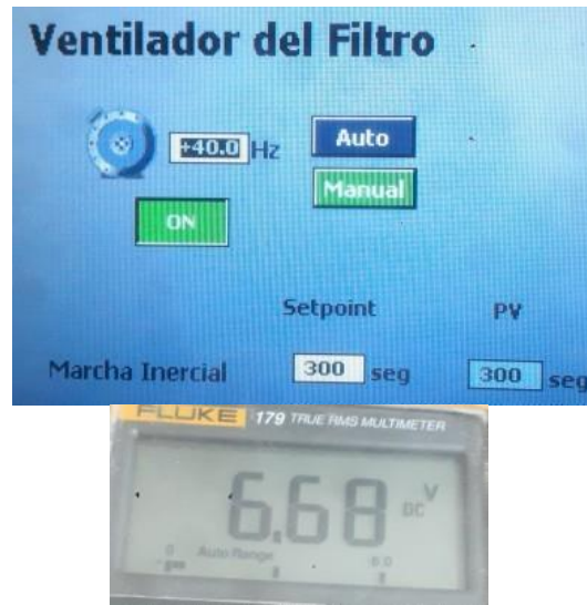
Figura 4.2: Pruebas desde el HMI a 40Hz.
