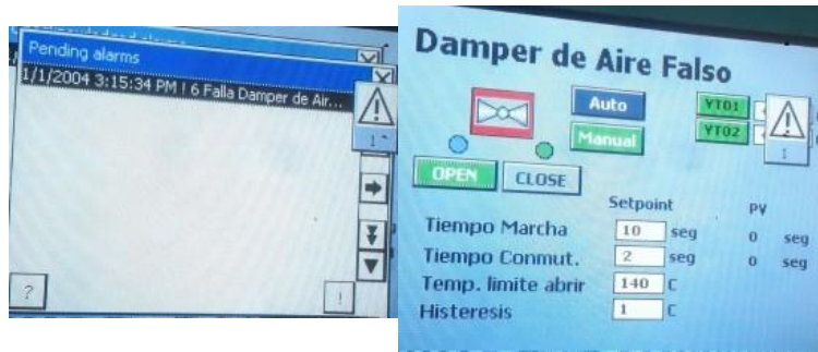
Figura 4.4: Pruebas de damper de aire falso en falla.
