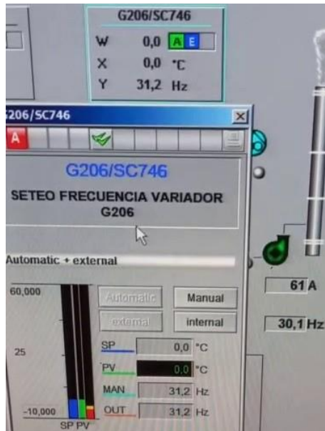
Figura 4.22: Comparativa de consignas tanto manual como automático de la frecuencia del variador G206.
