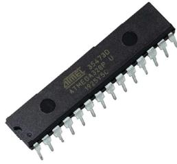
Figura 14. Microcontrolador ATmega328P
