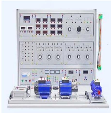
Figura 21: Banco de pruebas de motores eléctricos [27].
