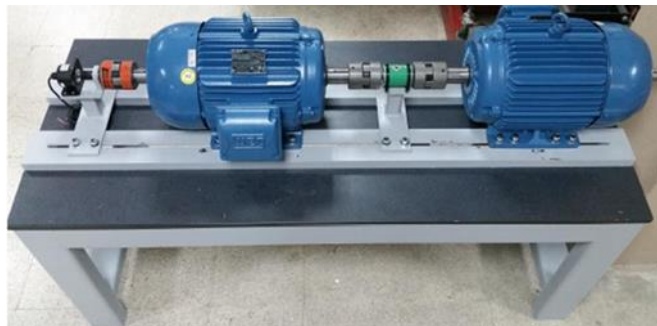
Figura 27: Ensamblaje de motores de inducción acoplados. [Fuente: Banco de pruebas de la UPS]
