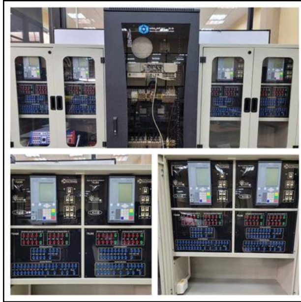
Figura 26: Tablero de pruebas para pruebas de dispositivos electrónicos inteligentes led's de control y protección de la Universidad Politécnica Salesiana. [fuente: Plataforma de pruebas de la UPS]
