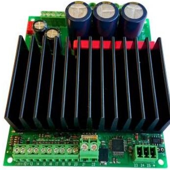
Figura 15: Controlador DC para un motor blcd. [18]
