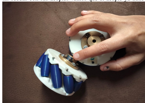
Figura 63. Paso 5. Luego, de poner las ruedas con sus acoples vemos que el acople ya tiene puesto un suprimidor. Sección A y B
