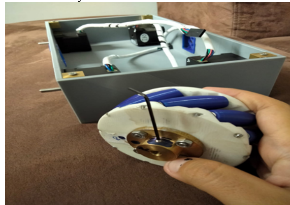
Figura 70. Paso 12. Ya puestos los 4 motores, nos toca colocar las ruedas y cada rueda tiene un acople y su prisionero. Primero con una llave allen vas desajustando, luego colocas en la rueda y así sucesivamente con las otras ruedas.
