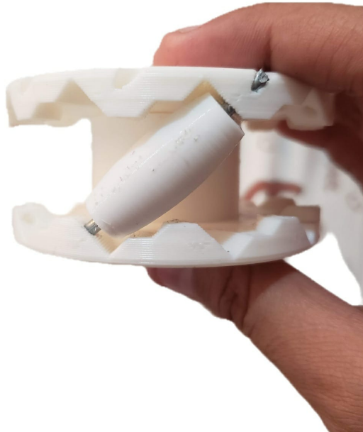
Figura 61. Paso 3. Montaje de las ruedas con las varillas de aluminio. Sección C y D.
