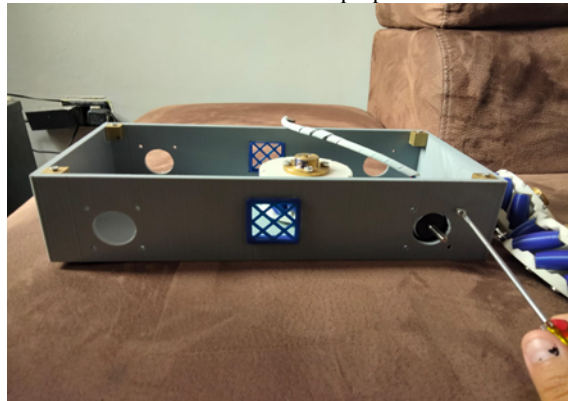
Figura 66. Paso 8. Se van colocando cada motor con su ruedas apropiadas como detalla el paso anterior. Sección A y B.
