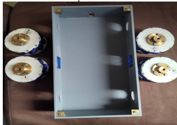
Figura 64. Paso 6. Una vez terminadas las cuatro ruedas explicaremos cómo se va armando el cuerpo del robot. Sección A y B.
